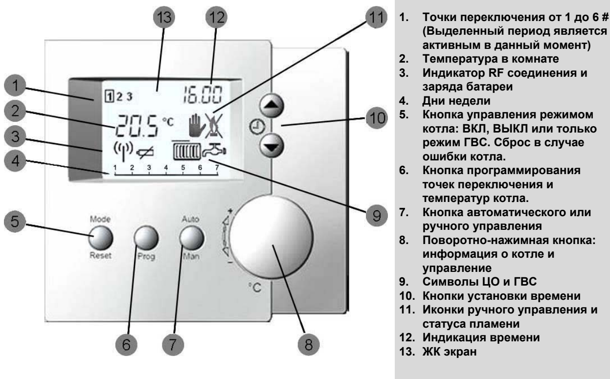
Рис 3: Проводной программируемый Simple MMI 7Days – интерфейс пользователя.
